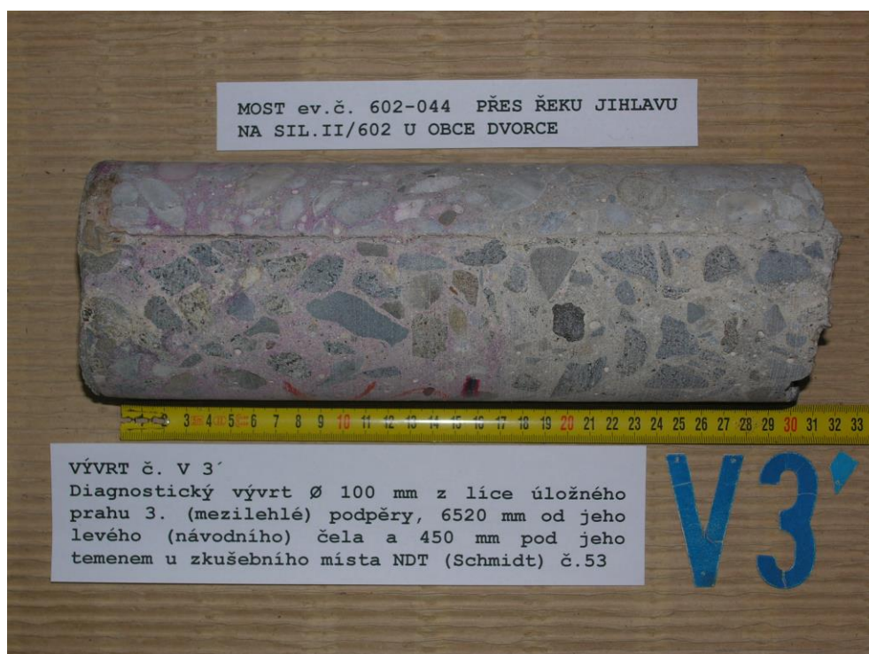
Obr. F32-205 VÝVRT č. V 3' . Diagnostický vývrt Ø 100 mm z líce úložného prahu 3. (mezilehlé) podpěry, 6520 mm od jeho levého (návodního) čela a 450 mm pod jeho temenem u zkušebního místa NDT (Schmidt) č.53,
