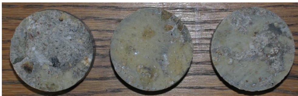
Obr.F32-303 Zkušební terče číslo 20, 25, 39 (zkušební místo 3) po provedení odtrhu.
