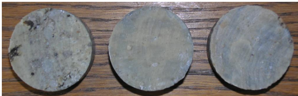
Obr.F32-301 Zkušební terče číslo 140, 144, 145 (zkušební místo 1) po provedení odtrhu.
