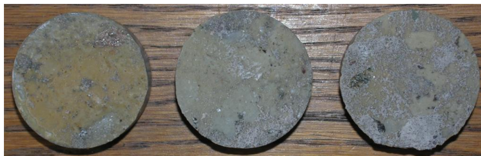
Obr.F32-302 Zkušební terče číslo 111, 106, 110 (zkušební místo 2) po provedení odtrhu.
