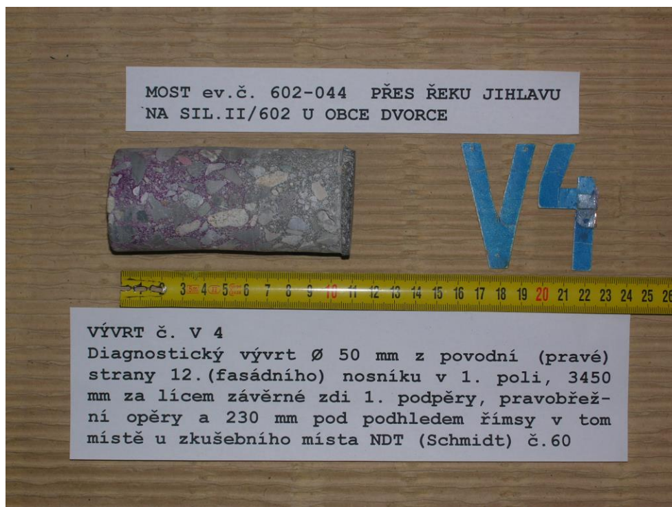
Obr. F32-206 VÝVRT č. V 4. Diagnostický vývrt Ø 50 mm z povodní (pravé) strany 12.(fasádního) nosníku v 1. poli, 3450 mm za lícem závěrné zdi 1. podpěry, pravobřežní opěry a 230 mm pod podhledem římsy v tom místě u zkušebního místa NDT (Schmidt) č.60.
