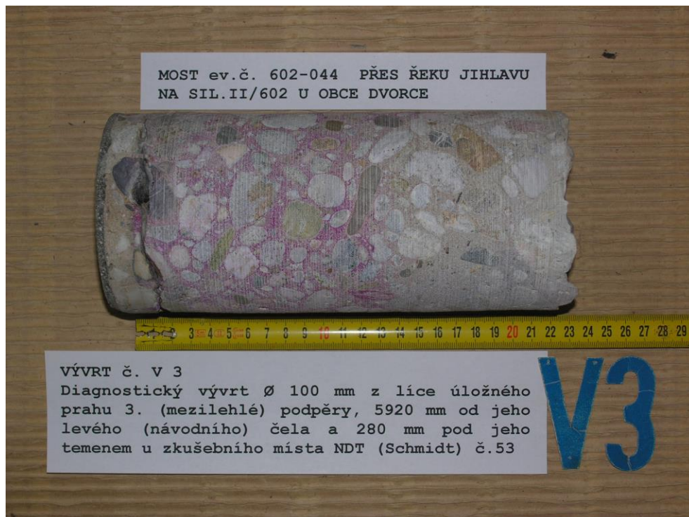
Obr. F32-204 VÝVRT č. V 3 . Diagnostický vývrt Ø 100 mm z líce úložného prahu 3. (mezilehlé) podpěry, 5920 mm od jeho levého (návodního) čela a 280 mm pod jeho temenem u zkušebního místa NDT (Schmidt) č.53.
