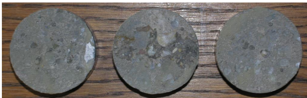
Obr.F32-306 Zkušební terče číslo 130, 134, 143 (zkušební místo 6) po provedení odtrhu.
