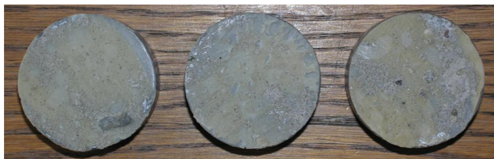
Obr.F32-304 Zkušební terče číslo 5, 8, 9 (zkušební místo 4) po provedení odtrhu.
