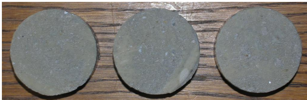
Obr.F32-305 Zkušební terče číslo 81, 82, 83 (zkušební místo 5) po provedení odtrhu.
