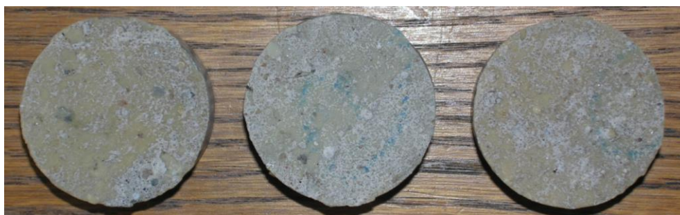
Obr.F32-308 Zkušební terče číslo 132, 141, 133 (zkušební místo 8) po provedení odtrhu.
