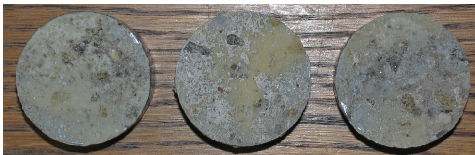
Obr.F32-307 Zkušební terče číslo 23, 51, 79 (zkušební místo 7) po provedení odtrhu.
